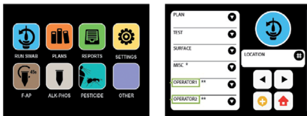
FIGURA 1 – El novaLUM® incluye una modalidad que dirige al operador al sector donde hisopar
