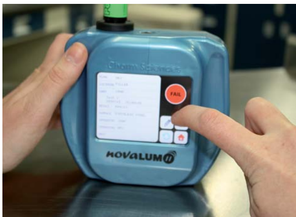
FIGURA 2 – El Pocket Swab Plus indica en tiempo real (5 segundos) si la superficie está limpia o sucia.
