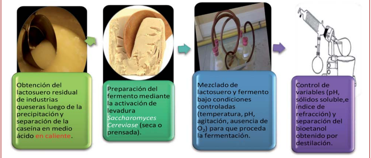
ESQUEMA 2 – Pasos en la producción experimental de bioetanol a partir de suero lácteo enriquecido con carbohidratos
