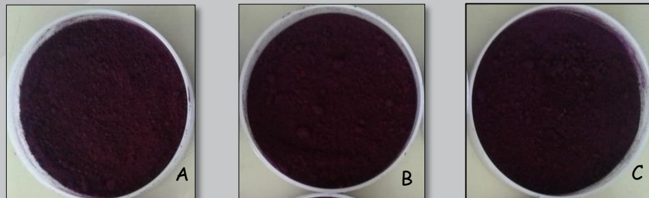
Fig. 1. Fotografía de los polvos a diferentes temperaturas de entrada. A) 130°C; B) 150°C; C) 170°C.
