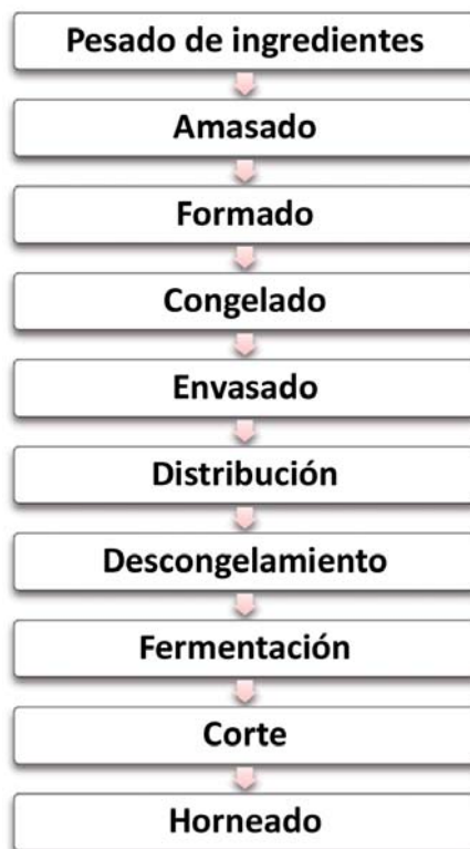
Diagrama de flujo de fabricación de pan por el método de masas congeladas
