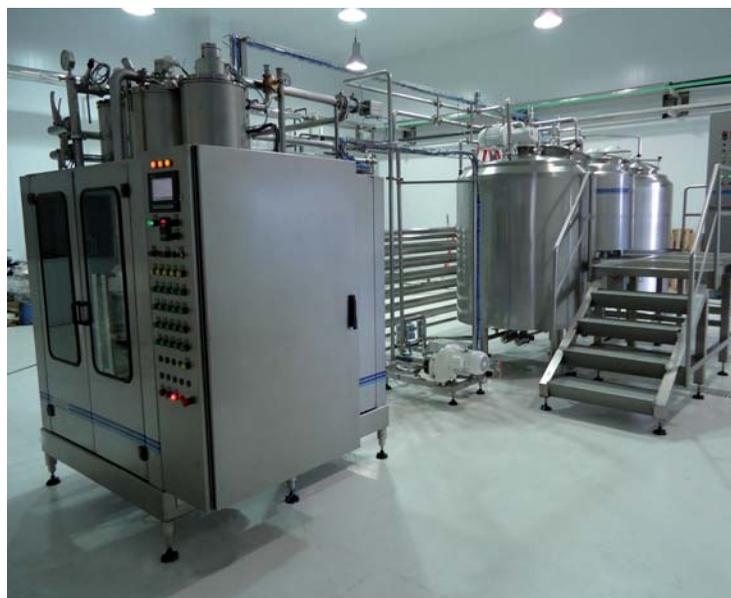
sistema de bombas positivas y cuadro de válvulas para el manejo de las distintas etapas del proceso. La configuración del mismo se realiza conforme a los productos a fabricar y las capacidades requeridas. Las principales características son:
