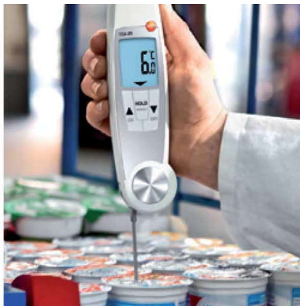
Figura 3 - Determinación de temperatura interior por penetración
