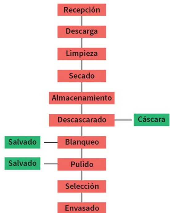
Figura 3 - Diagrama de flujo del proceso de elaboración de arroz
