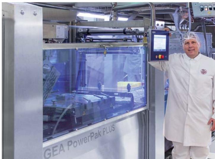
niveles de vacío superior e inferior son controlables y monitorizables, asegurando la transparencia necesaria del proceso.
