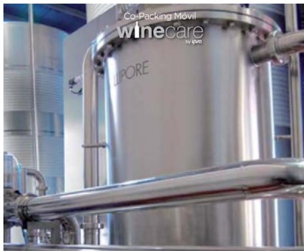
**Sistema de filtración de flujo normal Millichilling para vinos complejos y estructurados. Millipore by Merck.**
