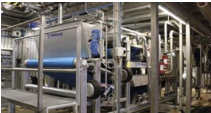
La prensa de cinta Flottweg desagua la pulpa de papa en un proceso continuo hasta alcanzar el mayor total posible de sólidos secos. El agua utilizada puede ser reabastecida al proceso.
